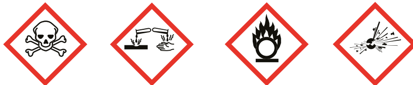
Figur 19. Märkning av produkter med giftigt, frätande respektive oxiderande innehåll, samt explosiva varor.
