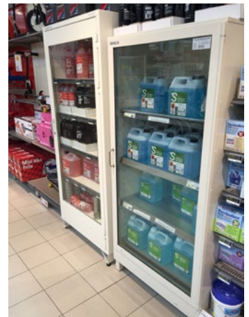
Figur 22. Skåp testat och certifierat enligt SP 2369 version 1-5, märkta SP2369 klass 1. Foto: David Gårsjö
