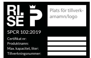
Figur 21. Texten SPCR 102:2019 visar att skåpet är godkänt för samförvaring.
