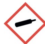
Figur 14. Varningsskylt för gasflaska, gas under tryck 22 . Skylten ska där gasflaskor förvaras kompletteras med tilläggs texten "Gasflaskor - förs i säkerhet vid brandfara".
